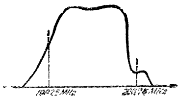
Фиг. 1-26. Честотна характеристика при настройване на осцилаторния тример за девети канал
